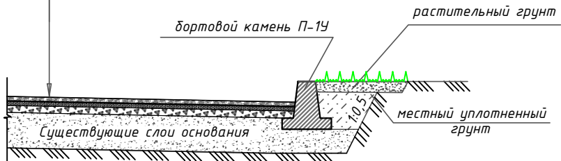
КРЕПЛЕНИЕ БОРТОВЫХ КАМНЕЙ НА СТЫКАХ
